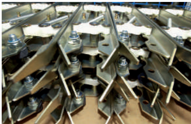
La culture ascenseur se trouve depuis l'origine au cœur de l'activité de Gabiot avec ici un système de serrure pour porte d'ascenseur.
