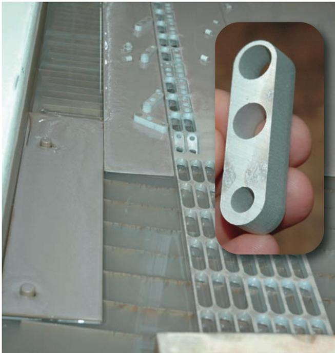
*Exemple de pièce en aluminium ne pouvant ni être poinçonnée, ni découpée thermiquement, que la technologie jet d'eau permet de réaliser.*
