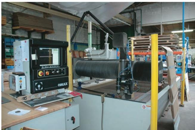
*Installé courant 2010, ce centre de découpe jet d'eau vient compléter la gamme d'équipements de production de la société Gabiot. Cette machine a permis de fabriquer en interne les pièces préalablement sous-traitées au laser. Il en résulte pour Gabiot une meilleure maîtrise de ses coûts, de ses délais et de son process industriel.*
