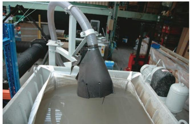
*L'eau, préalablement émulsionnée, est pompée et envoyée dans ce sac où par décantation d'une part et débordement d'autre part, elle s'épure naturellement de son sable.*
