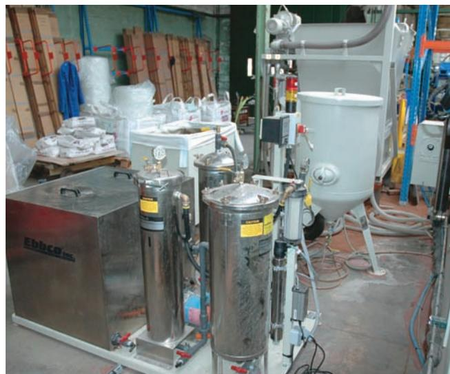
*Au premier plan, on peut voir le système EBBCO de traitement de l'eau avant retour à la pompe haute pression. Ce dispositif est composé d'un système de dé-ionisation, d'un générateur d'UV, de pré-filtres et d'une pompe à centrifugeuse. A côté, hors champ, un refroidisseur complète l'installation.*
